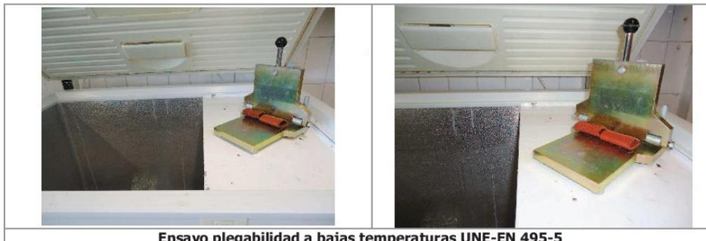
**Ensayo plegabilidad a bajas temperaturas UNE-EN 495-5**
